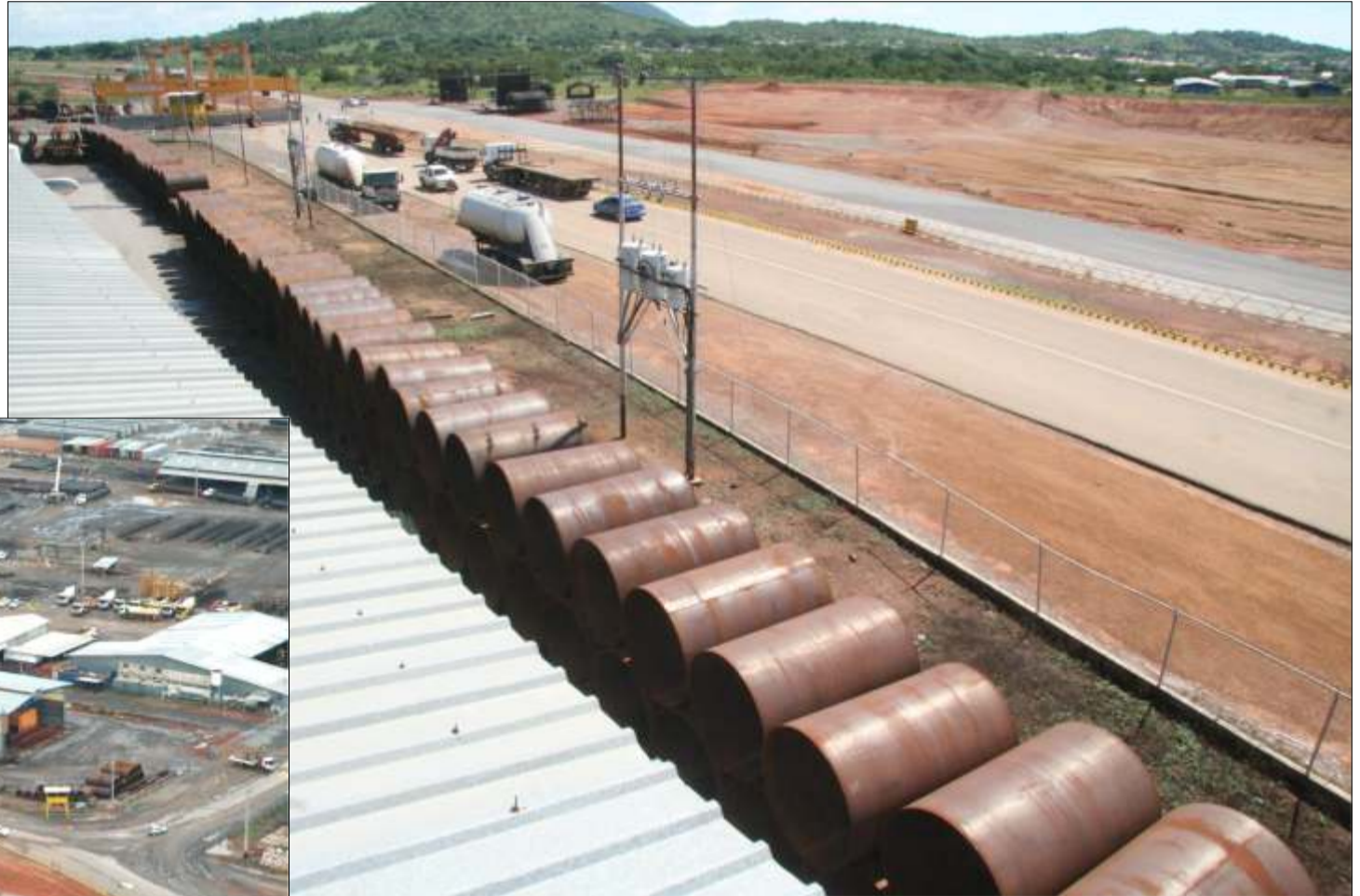
Línea de Producción Virolas de 3mts x 2 de diametro
