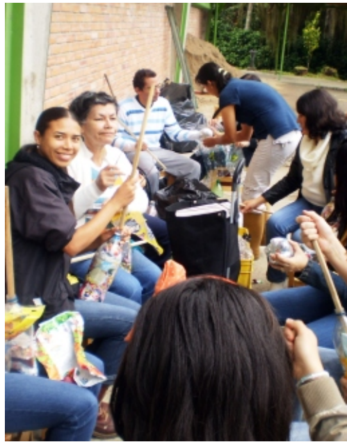
Elaborando el Ladrillo “Ecológico” con empaques postconsumo.
